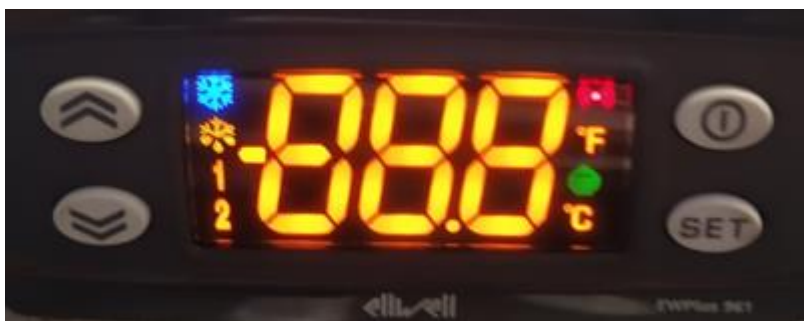
Рис. 3.3.1. Індикація та елементи управління контролера Eliwell.
