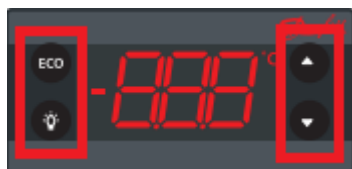
Рис. 3.1.2: Елементи управління контролера Danfoss ERC112C.
