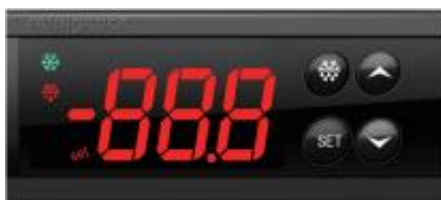
Рис. 6. Елементи управління контролера Elitech
