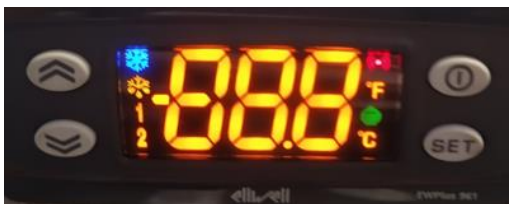
Рис. 4. Індикація та елементи управління контролера Eliwell.
