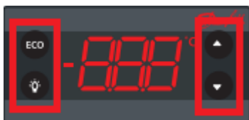
Рис. 5. Елементи управління контролера Danfoss ERC112.
